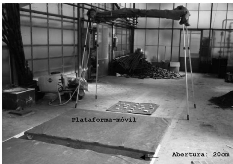
FIGURA 1. Plataforma móvil empleada en ensayos de tamaño de gota. Al fondo el simulador de lluvia con las lonas recogidas.
