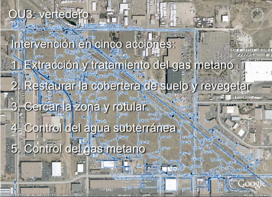
Para controlar el gas metano se excavaron 28 pozos que se controlaron al menos con una periodicidad mensual. Para su extracción se instalaron 75 pozos conectados a un sistema de vacío.
